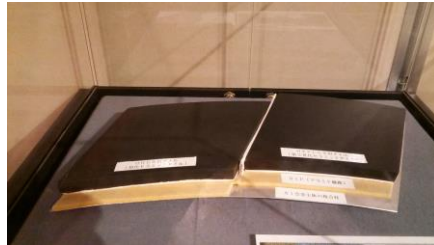
宇宙往還用実験機の断熱セラミックタイル
